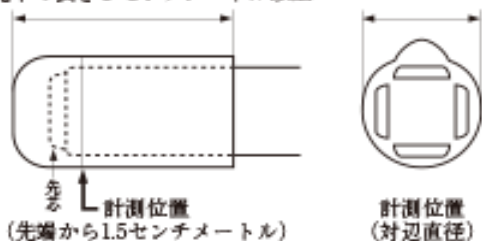
<竹刀の先革長、先端部最小直径値の計測方法>
